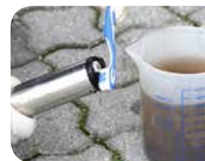
Abb. 5: Reinigung der Elektroden mit einer Zahnbürste und dem Überstand einer Probe aus der Biologie
