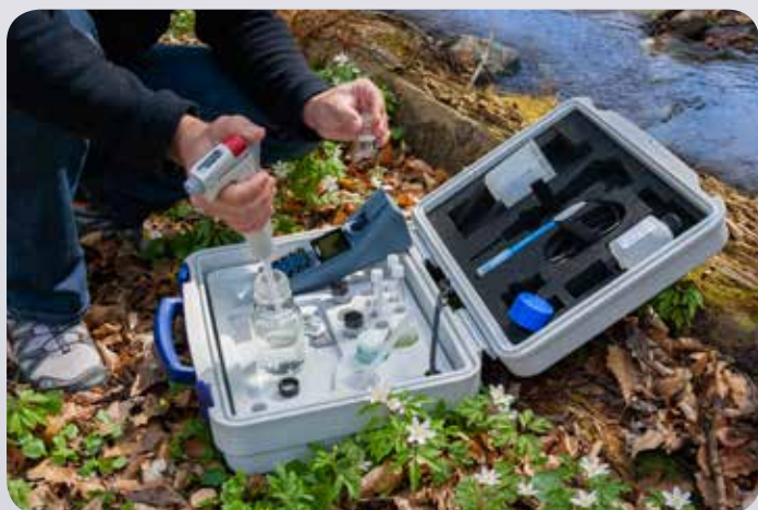
Abb.1: Der kleine Arbeitstisch im photoFlex®Turb Kofferset bietet Sicherheit bei der Bestimmung vor Ort
