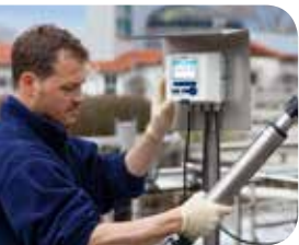
Abb. 3: System 282/284 mit fünf Parametern bei nur einem angeschlossenen Spektralsensor
